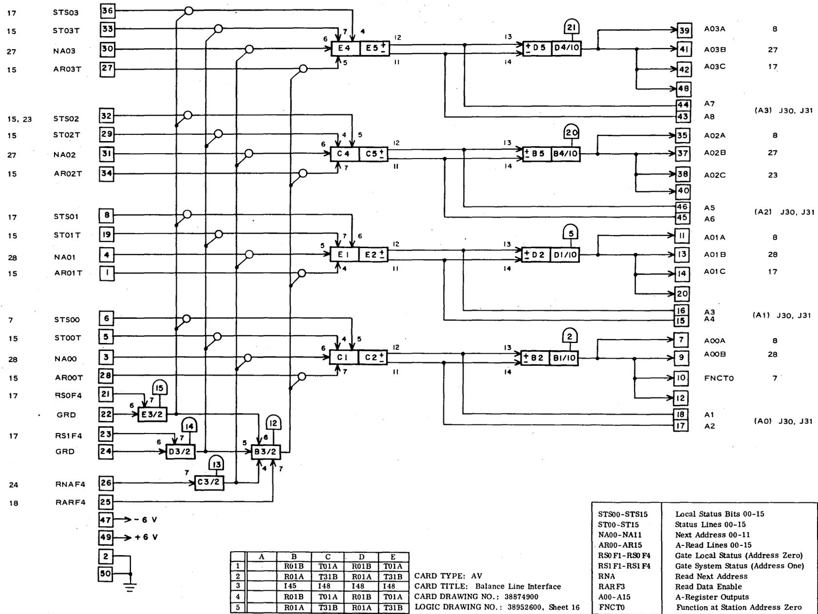
FIGURE 3.20. A-REGISTER INTERFACE: BITS 0-3 (CARD 16)
