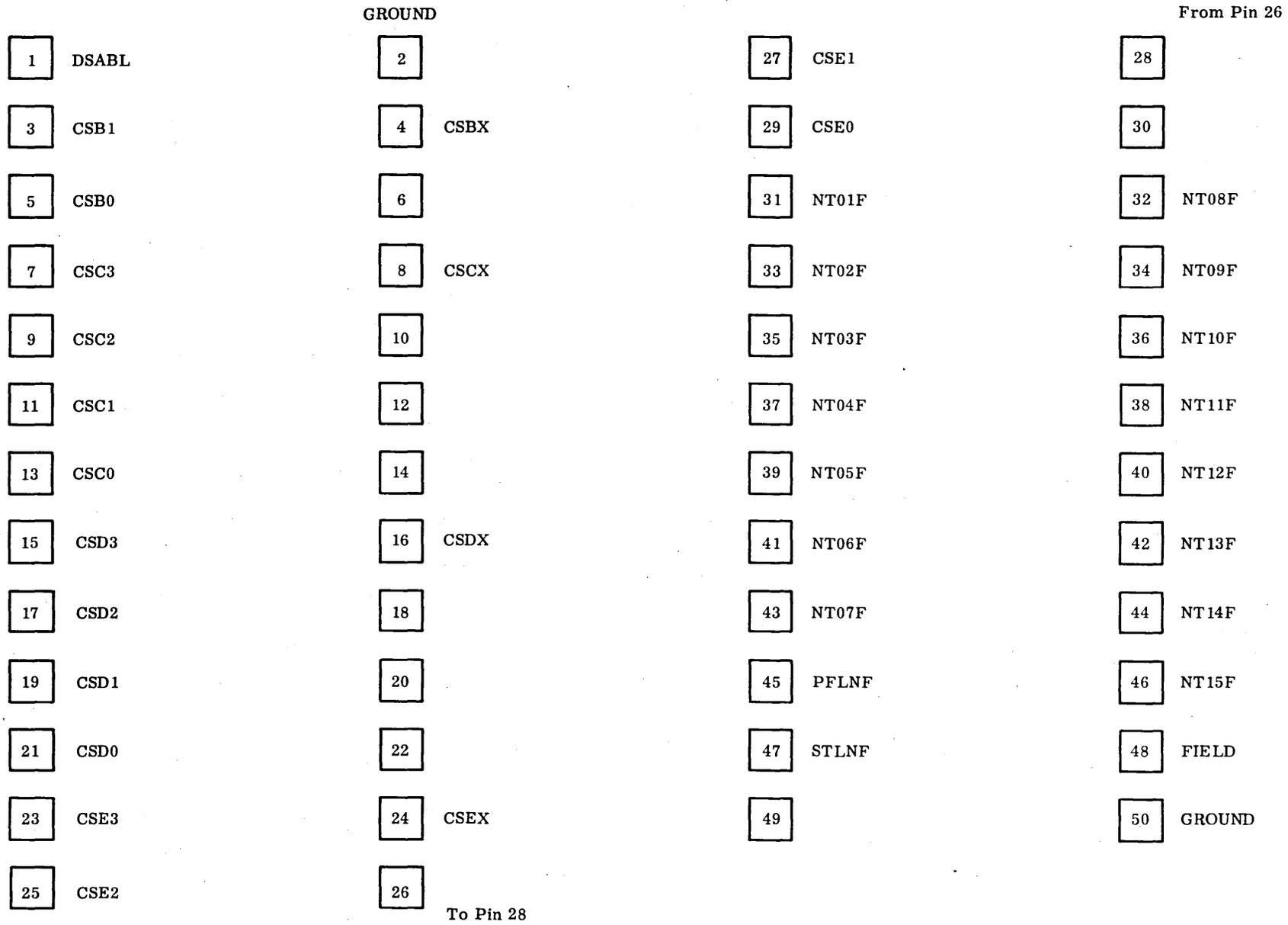
FIGURE 3.7. DCB CONNECTOR (CARD POSITION 3)
